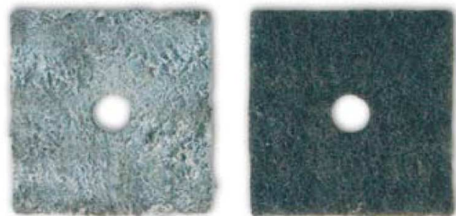
Zaprljani filter (slika lijevo); očišćeni filter (slika desno)
