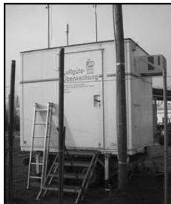
Slika 2.3. Automatska stanica za praćenje kvaliteta zraka Otoka
