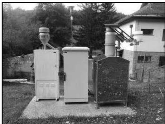
Slika 2.4. Automatska stanica za praćenje kvaliteta zraka Bjelave
